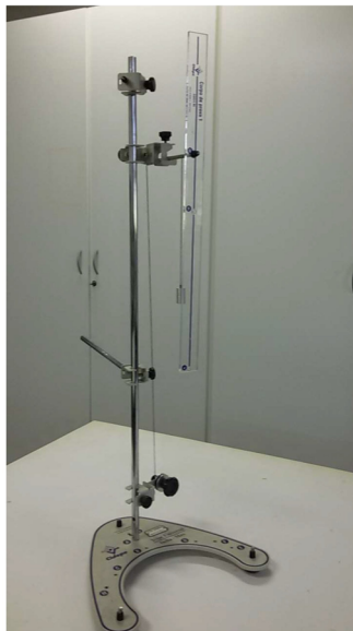
Figura 4 – Montagem do experimento com pêndulo físico.
