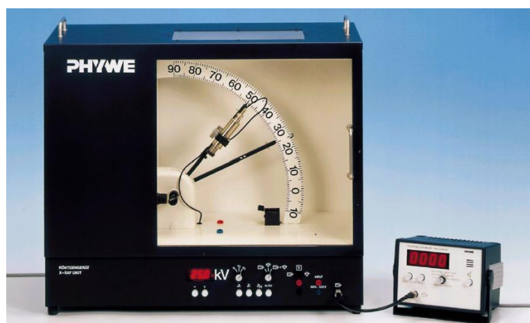
Fig. 4: Arranjo experimental para medida da intensidade de raios X espalhados para cada valor do ângulo \theta .
