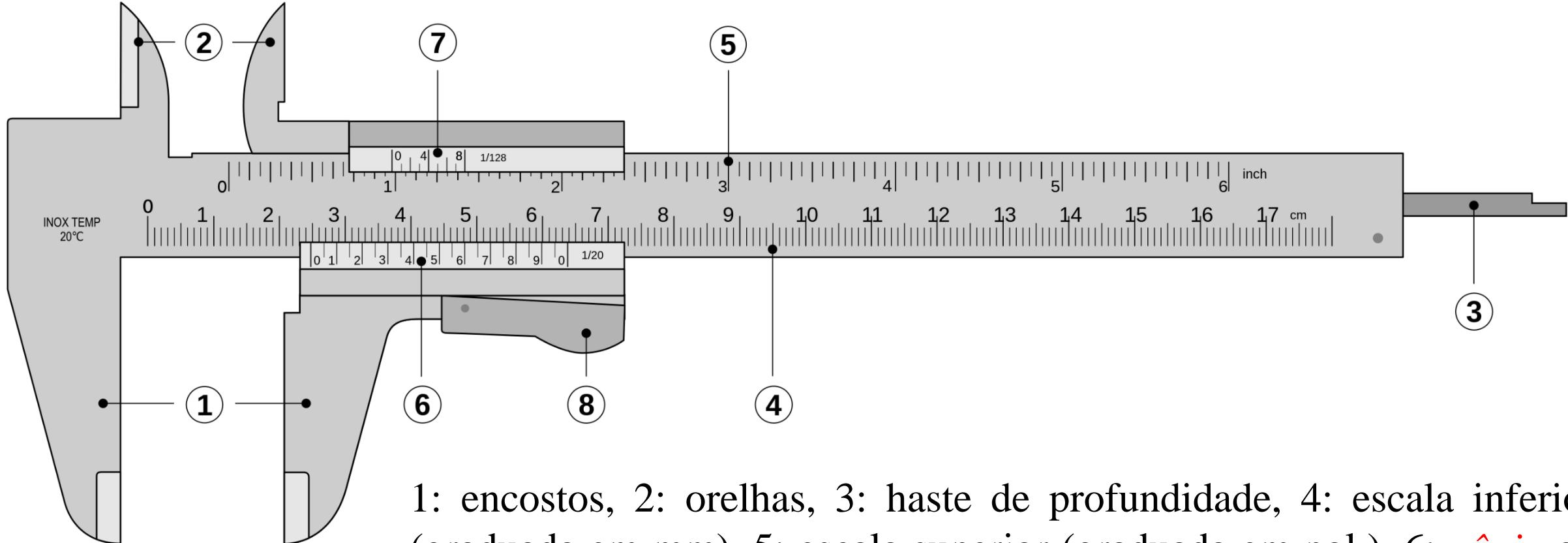
1: encostos, 2: orelhas, 3: haste de profundidade, 4: escala inferior (graduada em mm), 5: escala superior (graduada em pol.), 6: *nônio* ou *vernier* inferior (mm), 7: *nônio* ou *vernier* superior (pol.), 8: trava.
